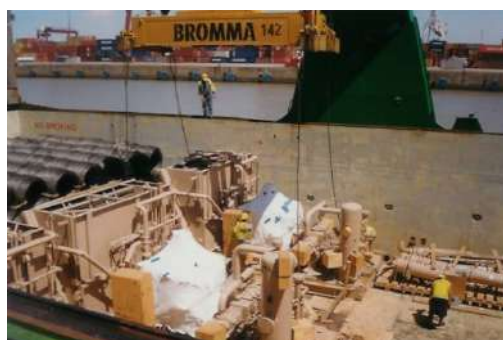
Equipos para la compresión de gas.
